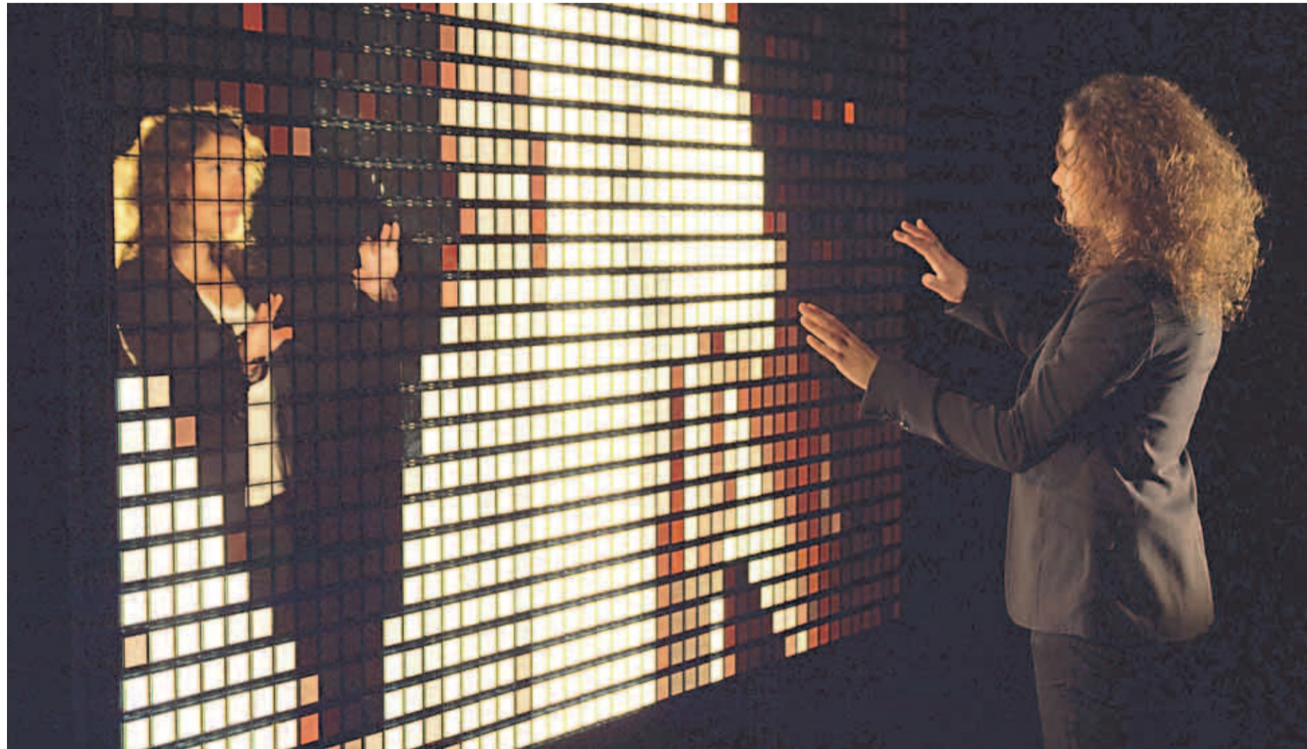
Durch OLED-Lichtelemente ergeben sich völlig neue Möglichkeiten der Wandgestaltung. Solche Lichttafeln können auch im Außenbereich eingesetzt werden Foto: Philips
